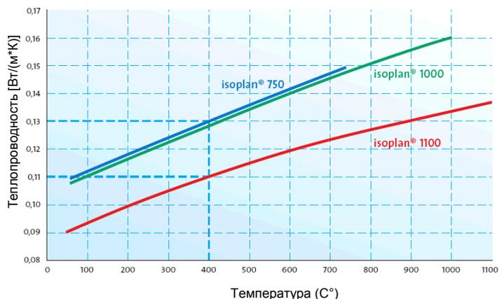
Кроме теплостойкости материала, показатель теплопроводности является решающим критерием теплоизоляционного материала. Теплопроводность характеризует способность тела передавать тепловую энергию (Вт) от одной его точки к другой при толщине 1 мм и площади поперечного сечения 1 м<sup>2</sup> при 1 Кельвине [Вт/(м\*К)], если между ними возникает разница температур.
