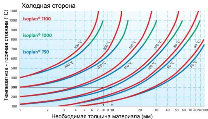
Посредством кривых в этом графике можно рассчитать необходимую толщину материала (в зависимости от его вида) при заданной температуре на "холодной" и "горячей" стороне места применения. В показанном примере необходимая толщина материала isoplan® 1100 составляет 8 мм, isoplan® 750 и isoplan® 1000 толщина 10 мм.
