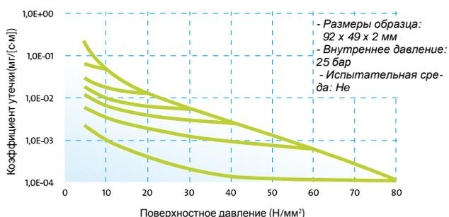
Новое поколение novatec® PREMIUM XP демонстрирует значительно меньшую утечку при стандартных уровнях поверхностного давления.
