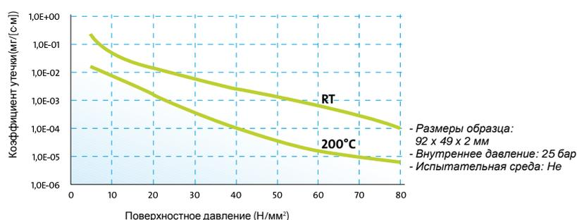
novatec® PREMIUM XP рассчитан на минимальный возраст утечки. Микропористость инновационного прокладочного материала уменьшается под воздействием температуры и давления на поверхности.
