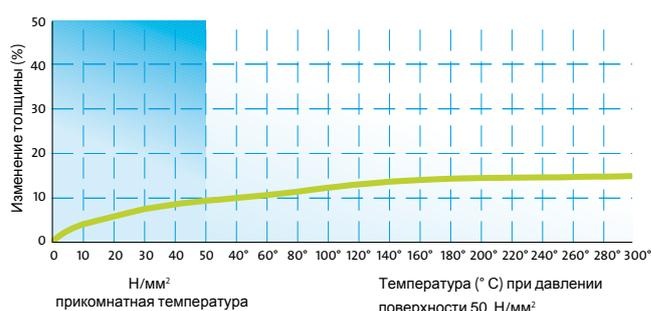
Толщина novatec® PREMIUM XP уменьшается в особенно незначительной степени под воздействием температуры. При 300 ° C толщина всего на 5% ниже, чем при комнатной температуре.
