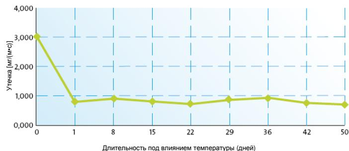
novaMICA® THERMEX показывает максимальную герметичность при высоких температурах.
